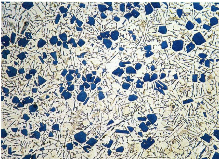
Рис.3 Заэвтектический силумин после обработки зерна фосфором
